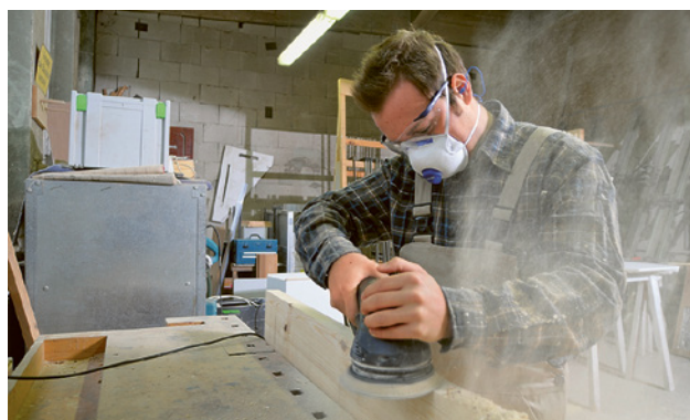
Fig. 5: demi-masque FFP2 pour le ponçage du bois. Afin de se protéger des poussières de hêtre ou de chêne, il faut toujours utiliser au moins un demi-masque FFP3 ou P3.
